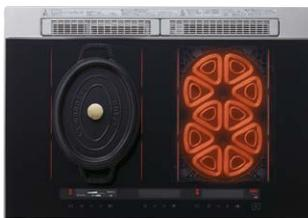
1つのインバーターで10個のピースコイルを制御する新しい加熱方式を採用。鍋の大きさや材質、煮込み調理、焼き物調理などの状態を判断して最適な加熱パターンを自動選択。主に6つの加熱パターンを切替えていくことで、きめ細かな加熱調節を実現します。
