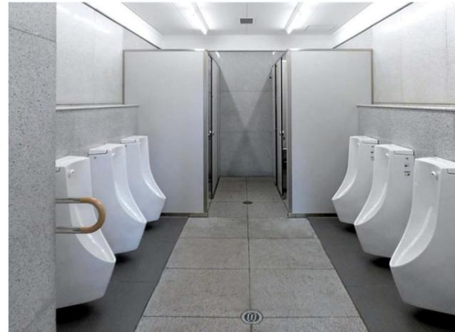
小便器の足元には、尿の飛散によるにおいや汚れを軽減するハイドロセラフロアを設置。安全性に配慮し、水濡れ時にもすべりにくいグリップタイプを採用している。
