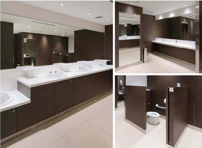
6Fトイレには、小さなお子様連れに配慮して幼児用大便器ブースを設置。保護者が外から見守ることができるように、間仕切り壁と扉は低く設置している。
