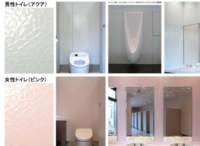
大便器ブースの壁面・小便器の前板・洗面コーナーの壁面などに透明釉柄のハイドロセラ・ウォールを採用。ひび割れた流水のような不規則な凹凸が、華やかな空間を演出している。
