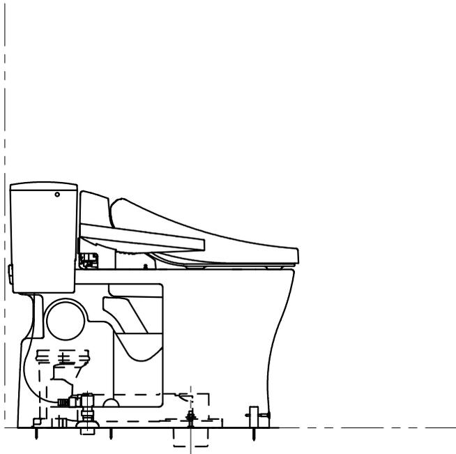
和洋リモデル工法における新設洋風便器のレイアウト上の制約条件
