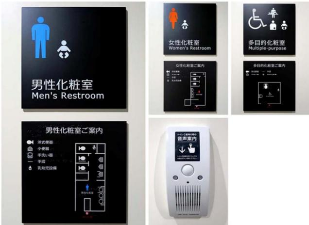
入口には、トイレ内の設備がわかる触知図を掲示。多機能トイレ内には、外国人配慮として、多言語対応(日・英・中)の音声ガイドを設置している。
