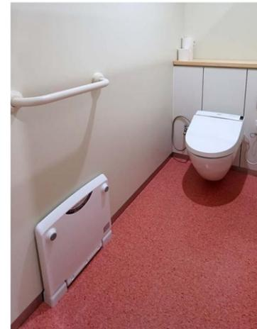
女性トイレにひろびろブースを1ヶ所設置。ストッキングの履き替えなどに配慮し、折りたたみ式の着替え台と手すり(高さ900mm)を設けている。
