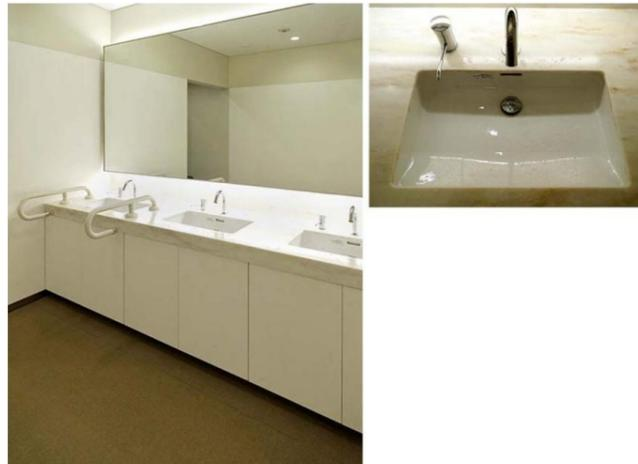
高齢者や杖歩行の方に配慮して、立位姿勢をサポートする手すり付きの洗面カウンターを設置。化粧鏡はバック照明付大型一面鏡を採用している。
