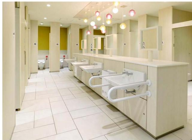
アイランドタイプの洗面コーナー。化粧鏡の形状や高さを抑えた設置により、混雑時でも空間全体が見渡せ、ブースの空き状況が一目でわかるレイアウトとなっている。
