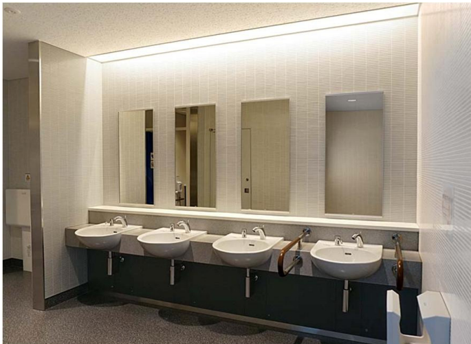
間接照明が利用者をあたたかく迎える洗面空間。洗面器のあふれ面高さは、車いす使用者の使いやすさにも配慮して750mmに設定している。
