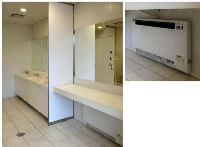
洗面コーナーは、ドライエリアに小物を置くことができるツインデッキカウンターを採用。写真手前側は、大きな手荷物を置く荷物棚を設けたパウダーコーナー。足元には、寒気に備えた、暖房用ヒーターを設置。
