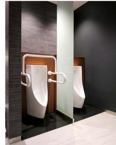
床の清掃性や節水性に優れた壁掛式の自動洗浄小便器を採用。手前の小便器には手すりを設置。プライバシーに配慮し、小便器の間に仕切りを設けている。
