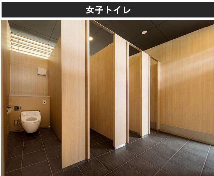
床の清掃性を考慮し、壁掛式大便器を採用。清掃方法は、通常は乾式清掃を実施しているが、登山者の利用が多いことから、泥汚れに対応して、湿式清掃もできるように、床タイルや排水口を採用している。
