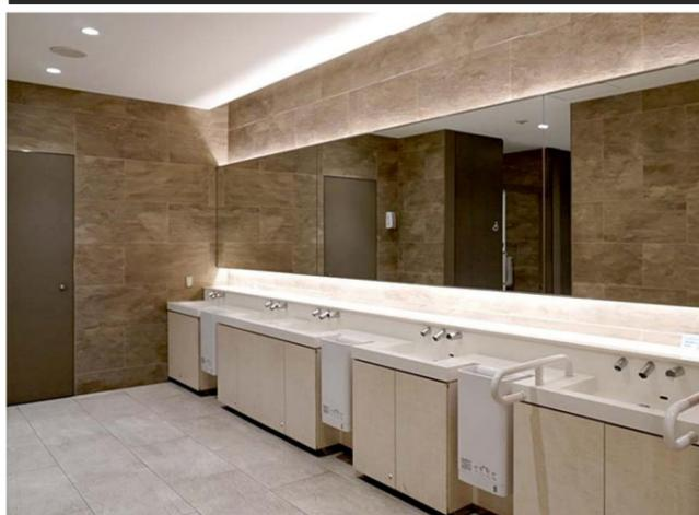
水濡れを心配せずに荷物を置くことができるように、ドライゾーンのあるツインデッキカウンターを採用。手洗い後の床への水垂れを抑えるために、洗面器の間にクリーンドライを設置している。
