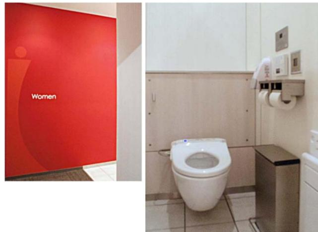
すべての大便器ブースにストッキングの履き替えなどができるフィッティングボードと、2度流しを防止する音姫(擬音装置)を設置している。
