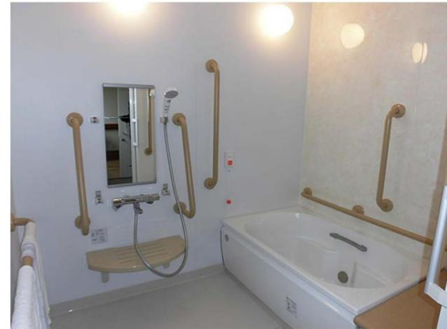
Bユニットの浴室は、自立の方と介護が必要な方、双方ともが安全に使えるように介護のしやすさと使い勝手に配慮した介護ユニットバス(1600×2000mm)に、座りながら入浴できるベンチを設置。
