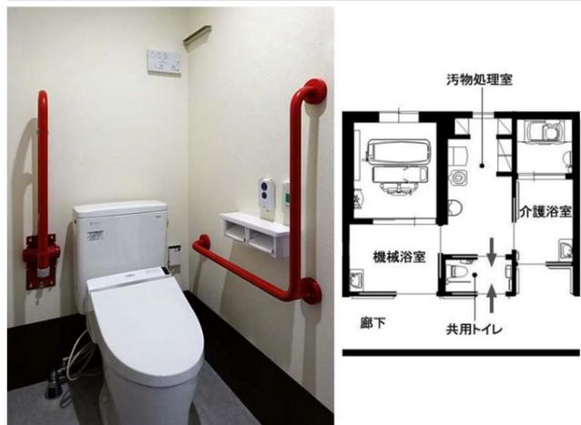
機械浴室・介護浴室に併設された共用トイレは、廊下側からもアプローチが可能。ウォシュレットのリモコンは誤操作を防ぐため、壁の高い位置に設置。必要に応じて介助者が取り外して使用するしくみをとっている。
