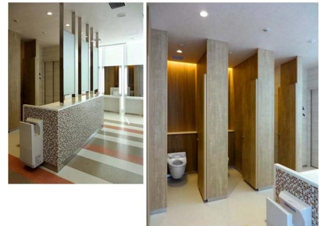
タイルで装飾されたアイランド型の洗面カウンターを設置。カウンター上の鏡は個別鏡とし、鏡奥の空間を見渡せる。防犯配慮として、全フロアで、大便器ブースの間仕切り壁は天井まで立ち上げている。
