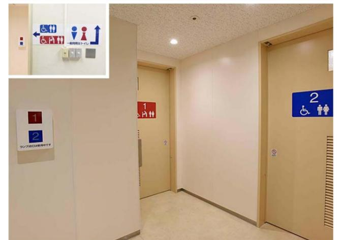
車いす利用者も利用しやすいよう、個室数より各個室内のスペースの確保を優先し、男女トイレを2カ所の多機能トイレへと改修。多機能トイレの使用状況は、廊下からもランプの点灯で確認できる。
