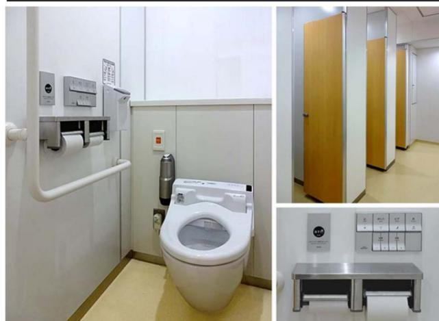
一部のブースには手すりを設置。ウォシュレットは、乾電池不要のエコリモコンタイプを採用。ブースの間仕切り壁は、天井まで立ち上げ、防犯対策とともに個室感を高めている。
