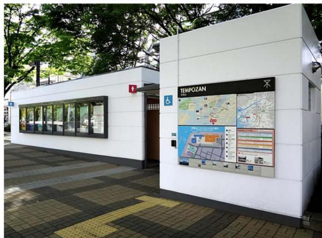
太陽と雨の力を利用し、セルフクリーニング効果で外壁を「真っ白」に保つ光触媒塗料ハイドロテクトカラーコートECO-SPを採用。防犯対策や維持管理のため夜間はシャッター施設している。(開錠時間：7:00～22:30)
