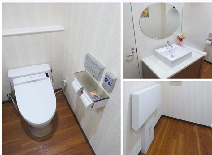
ボタンを押すと自己発電するエコリモコン搭載のウォシュレットPS2に空間を広く見せるコンパクトな形状と清掃性がよいフラッシュタンク式大便器を採用。幼児のおむつ替えのためのベビーシートも設置している。
