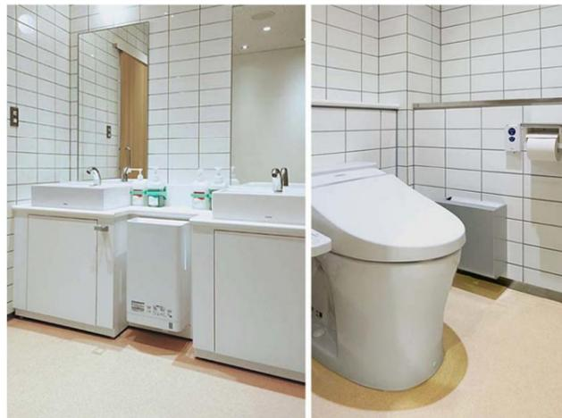
手洗い後の床への水垂れを抑えるため、洗面器の間にクリーンドライを設置。大便器はフラッシュバルブ式同様、連続洗浄ができるフラッシュタンク式を採用。大便器の後方と側面には荷物棚を設置している。
