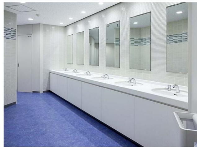
洗面器には、ノンタッチで水の出し止めができる自動水栓と水石けんを設置。
