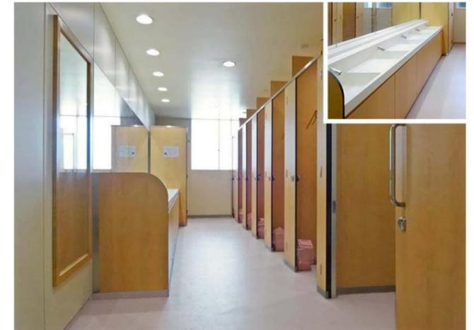
洗面コーナー横の壁には、身だしなみチェックのための全身鏡を設置。洗面カウンターは、洗面ボウルがコンパクトでボウル数を多く設置できる、ツインデッキボウル一体タイプ(奥行450mm)を採用している。
