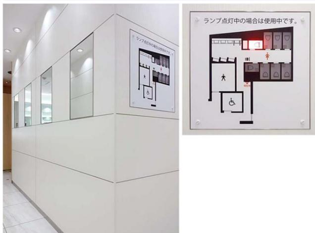
大便器ブースが空くの待つ間に「プレパウダーコーナー」として使用できるように、通路の壁に化粧鏡を設置。大便器ブースの使用状況は、手前のモニターで確認することができる。
