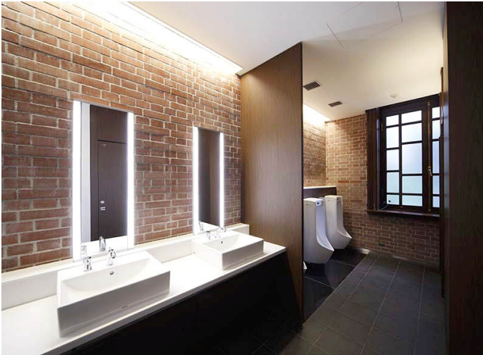
壁面は、レンガ躯体を内装に生かしたしつらえとなっている。女性トイレ同様、ハイクオリティ化粧鏡・ベッセル式洗面器を設置。
