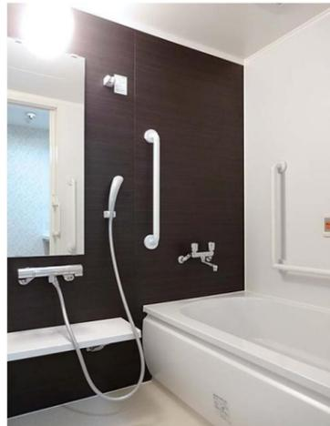
ダークブラウンのアクセントパネルが、落ち着いた雰囲気を演出。安全配慮としてバスタブへの出入りをサポートする手すりを取り付け、緊急時のために呼出ボタンを設置している。
