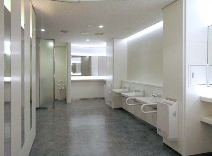
混雑緩和のため、洗面コーナーはゆとりのあるスペースを確保。洗面コーナーには鏡を設けず、両サイドにパウダーコーナーを配置している。壁材には耐傷性や衝撃にも強いハイドロセラ・ウォールを採用。
