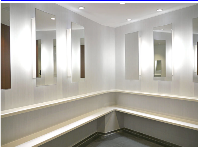
手荷物を置いてゆっくりお化粧直しができるように、2段式の棚を設けている。照明もお化粧直しのしやすさを考慮して、間接照明とダウンライトを組み合わせている。
