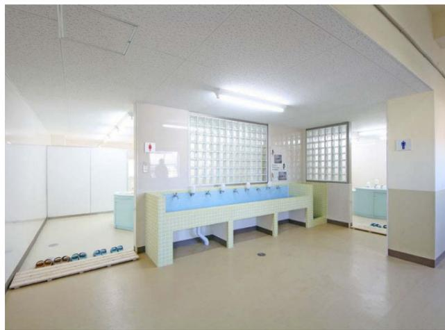
トイレ前には男女共用の手洗いコーナーを設置。壁面にガラスブロックを用いることで、廊下側の明るい光がトイレ内に届くように工夫をしている。
